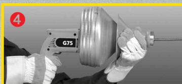
Die handliche Maschine ist mit einem patentierten Schiebe-Spannfutter ausgerüstet, das direkt in den Griffschutz eingebaut ist. Nach hinten geschoben arretiert das Futter die Flexikern®-Rohr-reinigungswelle, eine Bewegung nach vorne löst die Welle.
